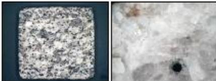
석명을 제외한 대부분의 입자들이 변색되어 있으며, 절리는 거의 Open Joint로서 절리면으로부터 상당히 깊은 곳까지 변질되어 있고 Core의 상태는 그대로 유지
